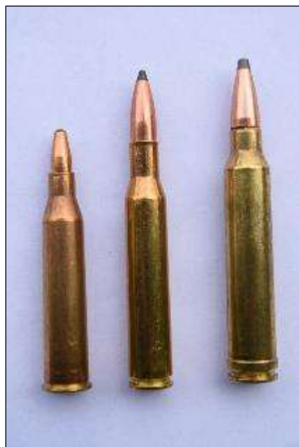
FIGURA 30: DA SX: CARTUCCIA CON COLLARINO 5,6x57R, SENZA COLLARINO 270 WINCHESTER, CON CINTURA SUL FONDELLO 300 WINCHESTER MAGNUM.
