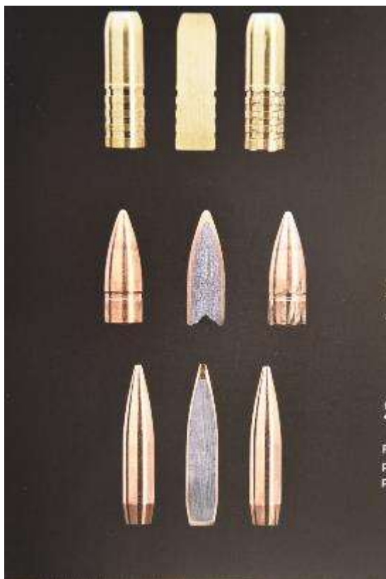
FIGURA 31: VARIE TIPOLOGIE DI PALLE SEZIONATE: DALL'ALTO PALLA MONOLITICA, AL CENTRO PALLA BICOMPONENTE, IN BASSO PALLA BICOMPONENTE ESPANSIVA CON FORO SULL'APICE
