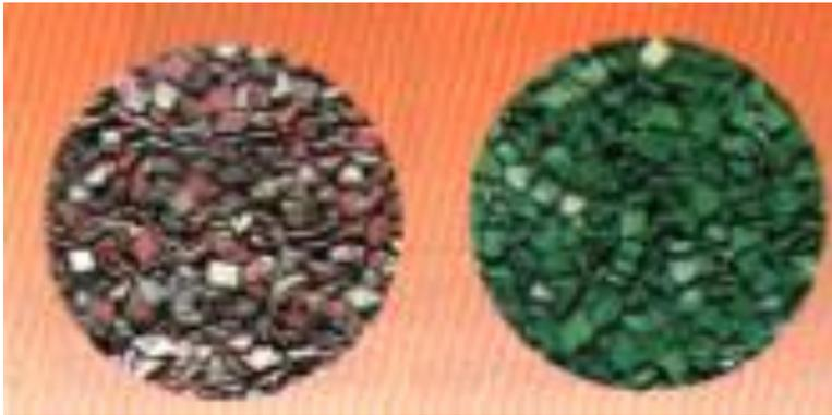
La polvere da sparo si distingue in polvere nera e polvera senza fumo. La polvere nera era un miscuglio di nitrato di potassio, carbone di legna e zolfo.
